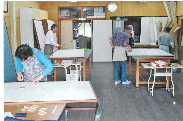
襖・障子張り作業
